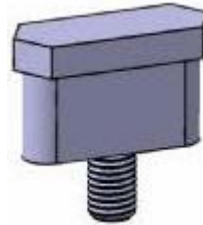
DIN 921: Langlochschrabe zum Ausschließen der Verstellmöglichkeit
