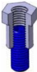
DIN 884: Teleskopschraube wenn Zweifel über die Länge bestehen
