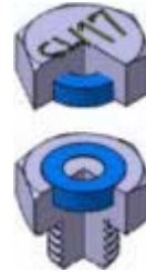
DIN 892: Magnet – Schraubenkopf zum schnellen Vortäuschen einer Verschraubung auch von hinten
