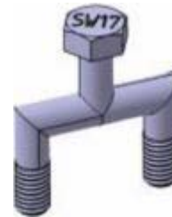
DIN 883: Sonderschraube zur Verringerung der Montagezeit
